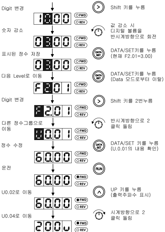
그림 4.2 디지털 오퍼레이터 TEST RUN (인버터 초기상태에 있을 경우)
